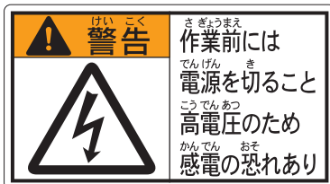
F 11 作業前警告ラベル
