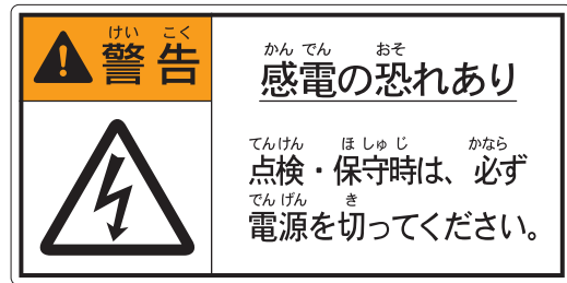
F 8 感電警告点検ラベル
